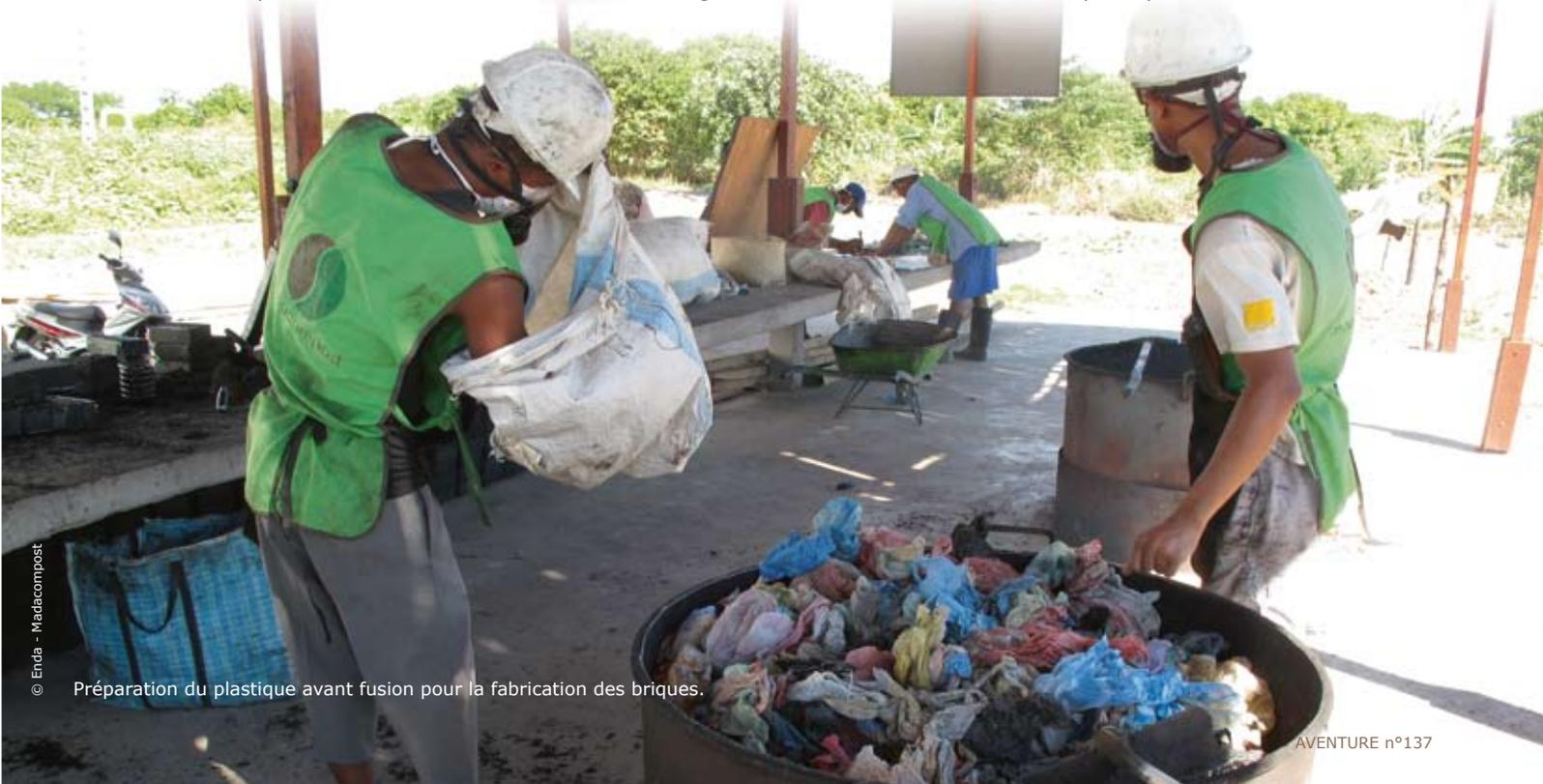
Préparation du plastique avant fusion pour la fabrication des briques.
