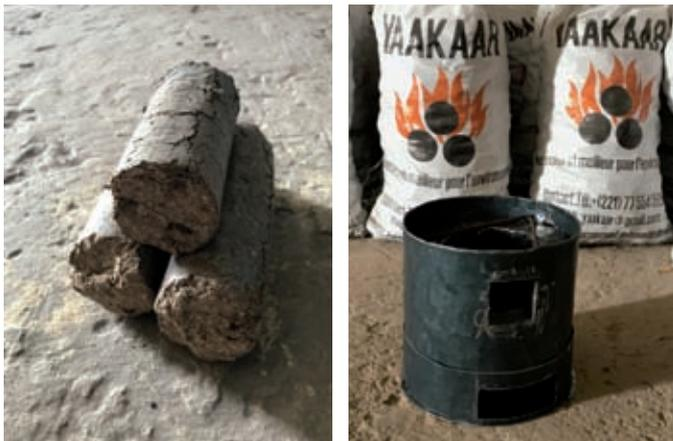
Fabrication des briquettes de coques d'arachide, au Sénégal, et fourneaux adaptées à ces biocombustibles. © Projets solidaires
