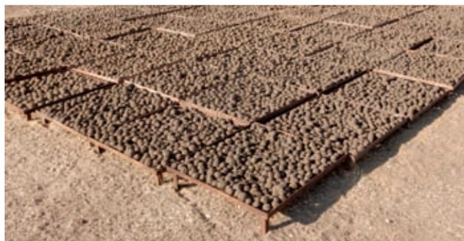
Boulets Yaakaar, fabriqué au Sénégal, à partir de coques d'arachides et d'argile et fourneaux adaptés à ces biocombustibles. © Projets solidaires.
